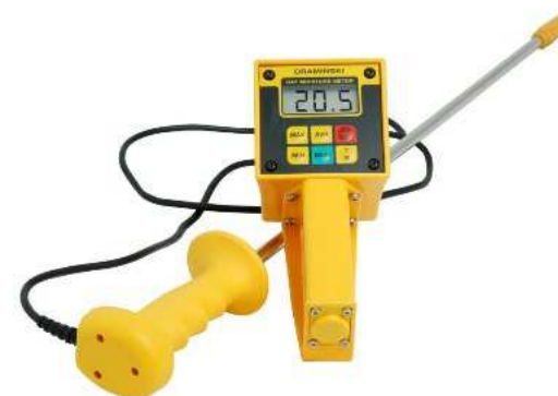
Анализатор влажности сена и соломы HMM
