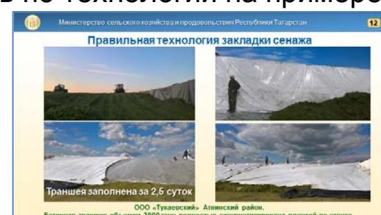
по стенке. Сенажная масса трамбуется тяжелыми колесными тракторами Нью Холланд и К-700. После закладки масса укрывается двойной пленкой разной толщины. Консервант вносится при измельчении и погрузке массы через Ягуар. К траншее подведена асфальтная дорога, что обеспечивает чистоту закладываемой зеленой массы. Организовано круглосуточное дежурство специалистов хозяйства. Траншея заполнена за 2,5 суток.
