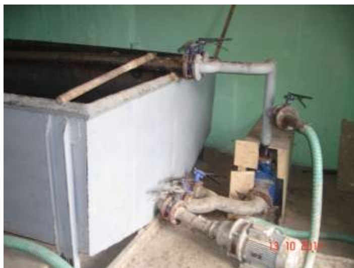
Фото 3 - Утеплённые ванны (2 шт.) на 2 тонны каждая для ферментации, с насо- сом для перекачки готовой ферментиро- ванной каши в кормораздатчик типа Де Лавль
