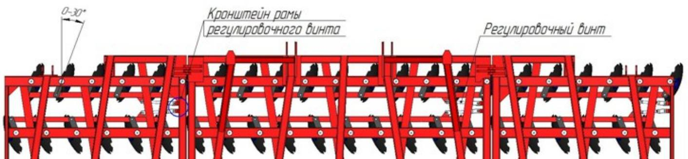
Схема установки дисков с заданным углом
