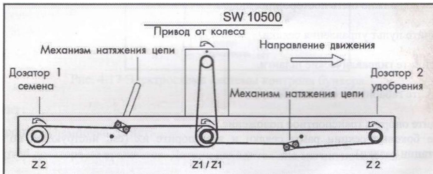
Цепной привод дозаторов
